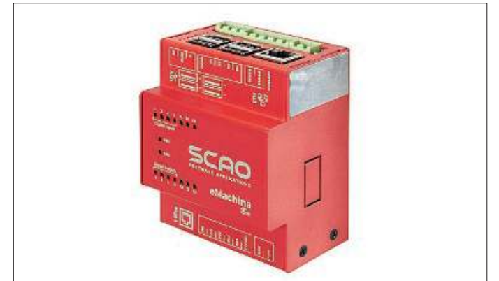
La soluzione. eMachina Box, dispositivo di Edge per macchinari datati
